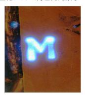
図 電子線照射した部分が p型化し、エレクトロルミネッセンスとして明る〈光っている。
