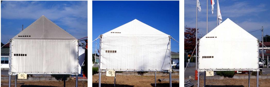
(A)一般膜材テント (B)フッ素処理膜材テント (C)光触媒膜材テント
