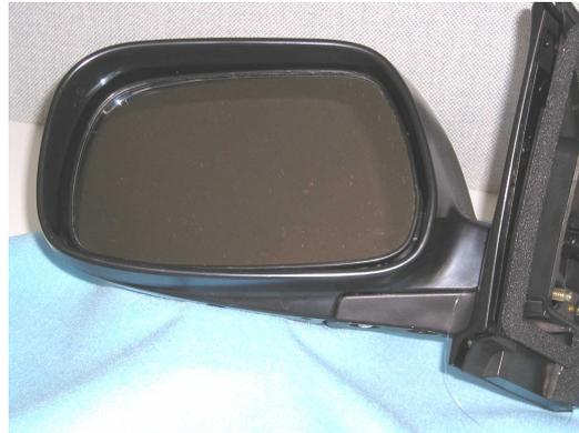
写真3 酸化チタンをコーティングした光触媒自動車用ドアミラー
