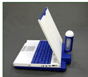
図7 カーボンナノホーンを使った燃料電池内臓ノートパソコン試作機
