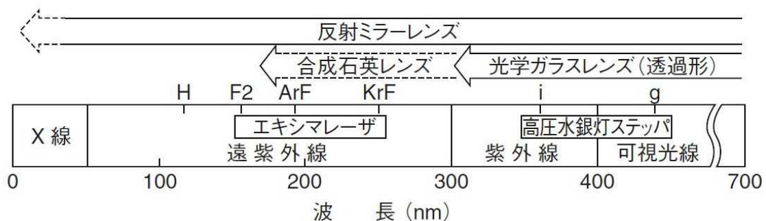
図 11 転写装置に用いる光の波長と光学系
